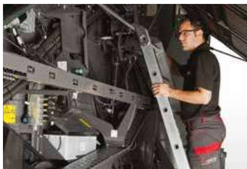
Рэйлинг для лестницы делает обслуживание более простым и безопасным
