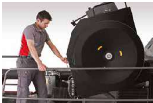
Простой и безопасный доступ к радиатору для очистки
