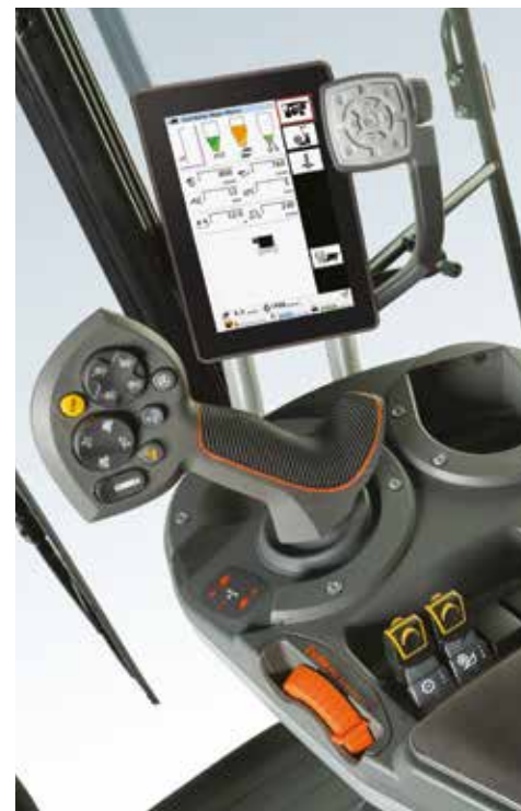
Вид оператора на основные органы управления
