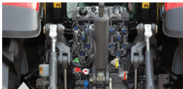
Все задние муфты снабжены системой сброса гидравлического давления.
