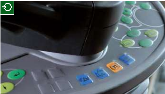
Мембранная клавиатура для блокировки навесного оборудования и активации амортизации.
