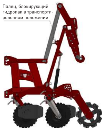
Рис. 11. Способ блокировки культиватора в транспортном положении.
