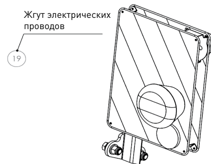
Световая сигнализация культиватора U-740 21.00.00
