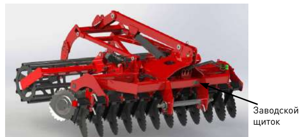
Рис. 2. Место крепления заводского щитка на машине
