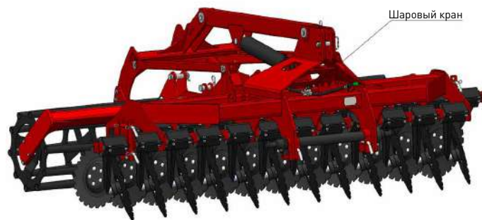
Рис. 11. Способ блокировки культиватора в транспортном положении.
