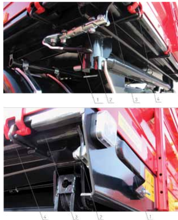
Рис. 5. Запоры бортов грузового кузова
