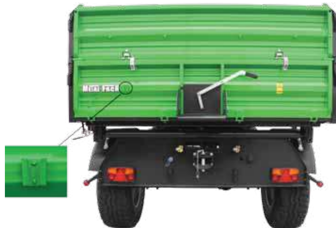
Рис. 4. Размещение опознавательного знака тихоходных транспортных средств
