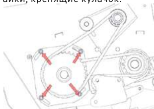
Рис. 33. Регулировка кулачка подборщика.
