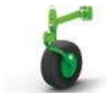
Переднее копирующее колесо, прикрепленное к передней части сцепки машины
